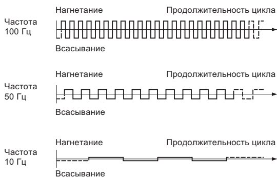
Рис. 43 Отношение частоты электродвигателя к производительности
